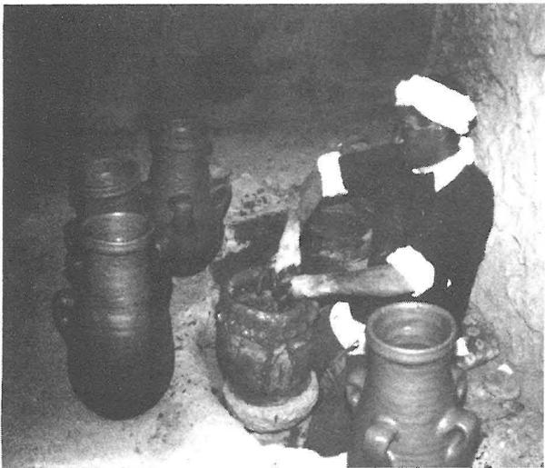
Photo 8 - La calotte d'argile obtenue est placée sur le tour et complétée au colombin, avant le tournage proprement dit (région d'Erfoud).
