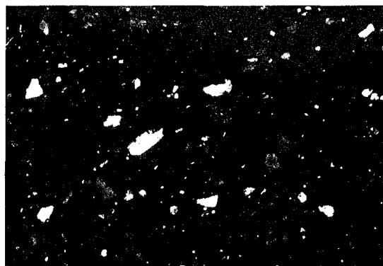
Figure 3 - Catégorie 2, dégraissant mixte carbonaté - volcanique à prédominance carbonatée. Polariseurs croisés, la largeur correspond à 3.5 mm.
