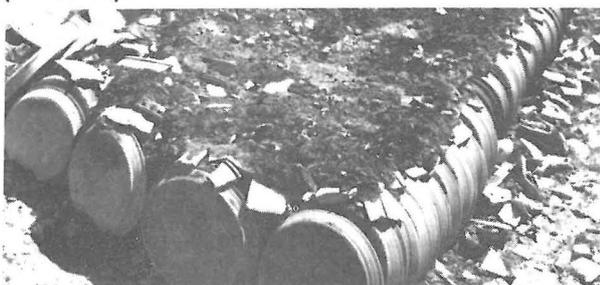
Photo 10 - Cuisson en meule. La cuisson commencée la veille au soir est achevée. Tout le combustible composé de bouses de vaches et de branchages s'est consommé (région de Fès).
