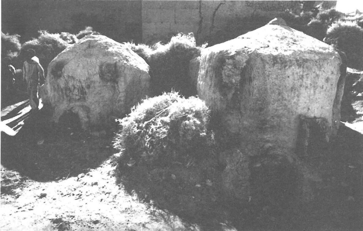
Photo 14 - Fours à voûte (région d'Erfoud). Ce type de four est le plus rare et n'est utilisé que pour les céramiques vernissées. En fin de cuisson, toutes les ouvertures sont bouchées pour permettre un refroidissement lent et régulier.
