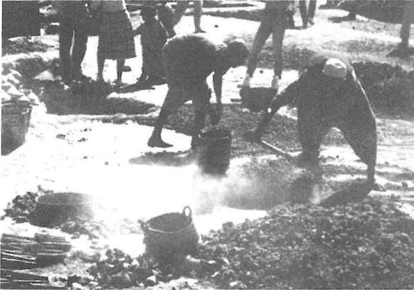
Photo 2 - Trempage de l'argile dans l'atelier de Tamegrout ; l'argile grossièrement broyée est précipitée dans une fosse remplie d'eau (région de Zarora).
